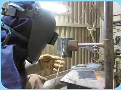
Soldagem eletrodo revestido
