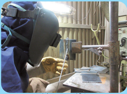
被覆アーク溶接
