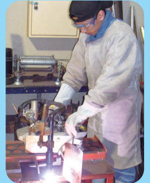
プラズマ切断
