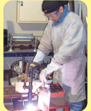
せつだん プラズマ切断
