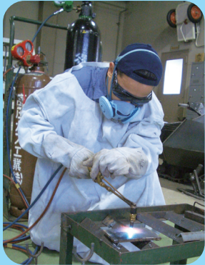
Soldadura y corte a gas
