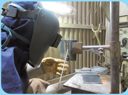
Soldadura electrodo revestido
