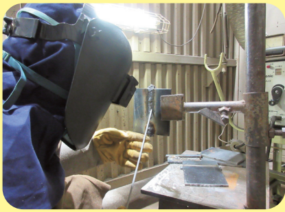
Soldadura electrodo revestido
