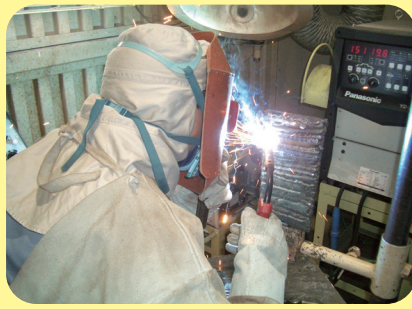
Soldadura CO 2 ・MAG
